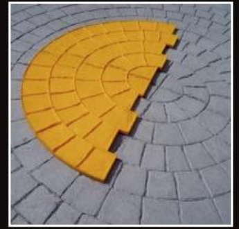
Gatstencirkel ca 150cm eller 270 cm i diameter. Betongen genomfärgad grå. Mönstret finns som gummi matris.
